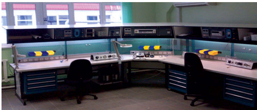
Рис. 1. Стенд для поверки/калибровки/ремонта СИ давления, температуры, электрических сигналов
