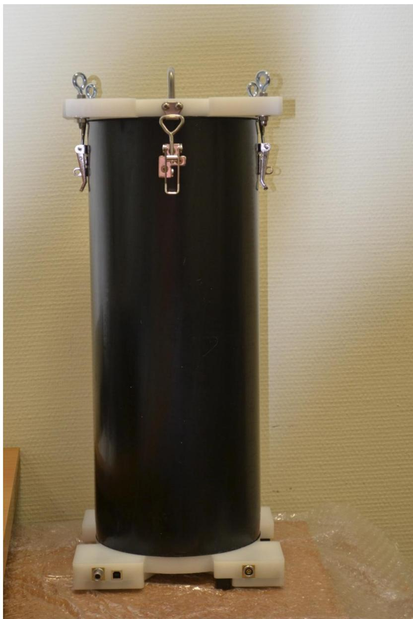
В верхней крышке камеры расположен крюк для подвески камеры к потолку для исключения влияния вибрации на измерение. Камера имеет длину 50 см и диаметр 20 см. В камеру встроены 3 разъема: LEMO 10 pin , LEMO 3 pin и USB.
