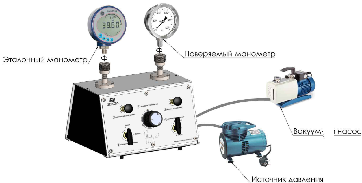
Рис. 5.1 Схема внешних соединений стенда КС-2
